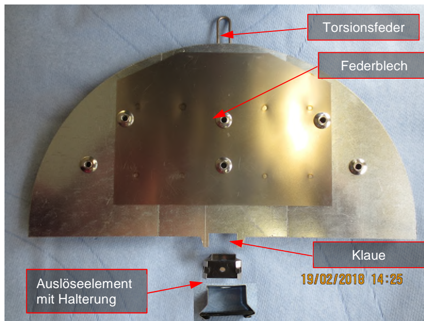
Abbildung 4: Klappenblatt und Auslöseelement nach Demontage
